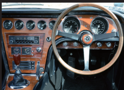
採用桃花心木製的方向盤。七個儀錶從左至右依序為：燃油表、油壓表、油溫度表、水溫表、電流表、轉速表和速度表。
