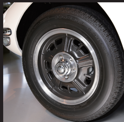
輪胎採用輕量的鎂合金輪圈。同樣採用賽車使用的中心鎖式設計，左右輪螺絲緊固方向不同。
