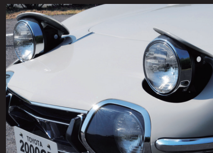
由於前方車頭較低，導致車頭燈的高度不符合當時的法規，因此採用了收納式頭燈。這個機制本身也是豐田2000GT強烈個性的一部分。
